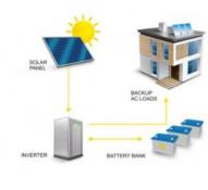
نظام الطاقة الشمسية المعزول عن الشبكة The Off-Grid or Stand-Alone PV System incorporates large amounts of battery storage to provide power for several days (and nights) when sunlight is unavailable. The array of solar panels must be large enough to provide for all energy needs at the site while simultaneously recharging the batteries. يشتمل النظام الكهروضوئي غير المتصل بالشبكة أو ما يعرف بالنظام المعزول على كميات كبيرة من
